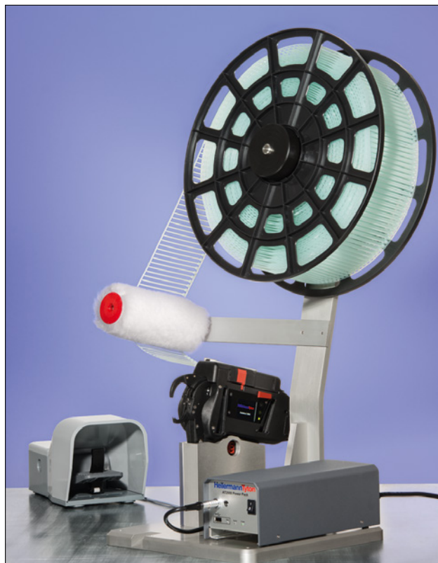
Accesorio de Puesto Fijo (Banco), rollo de bridas, Autotool 2000 y Fuente de Alimentación.
