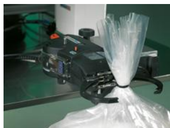
Tres medidas de mordazas, (30-50-80) mm. que optimizan el tiempo de atado en diferentes diámetros. Cierre de bolsas plásticas.
