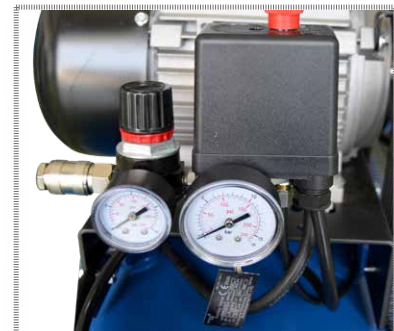
Regulador de presión con manómetro y conexión con enchufe rápido (modelos con ruedas).
