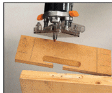
• Colocación de pernios con plantilla.
