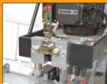
• Inserción semi automatica de las bisagras. Muy preciso y rapido.
