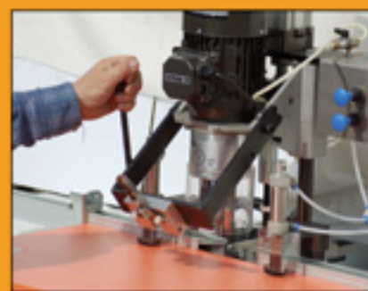
• Inserción semi automatica de las bisagras. Muy preciso y rapido.
