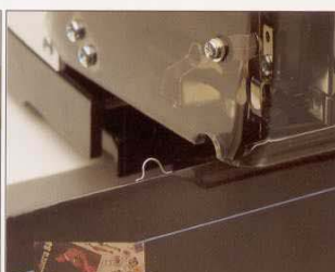
Engrapado y troquelado simultáneo. En la Rapid 101 puede montarse fácilmente un elemento engrapador Rapid 252/101 para grapas de archivo.
