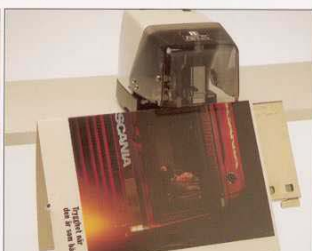
La Rapid 101 para cosido de caballete. Los topes ajustables permiten una colocación exacta de las grapas.
