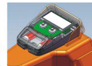
Display alimentado con 2 pilas AA (2x1,5V) ubicado bajo la tapa sellada
